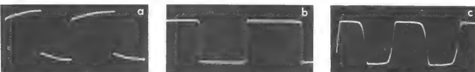
Bild 9. Oszillogramm der Brumm- und Rauschspannung des Hauptverstärkers bei linear eingestelltem Frequenzgang
